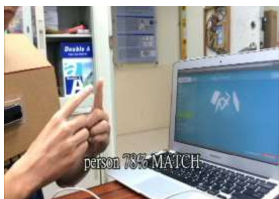
圖三、Leap motion 與 Leap Trainer 整合。圖中使用者比出手語「人」，螢幕正確辨識出人，並顯示符合程度 78%。
