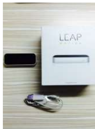
圖一、Leap motion 手勢擷取裝置。此裝置內含兩個攝影鏡頭，可偵測立體空間內，手掌及手臂的動作。
