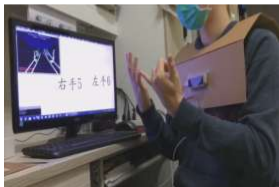
圖二、Leap motion 與 Processing 程式語言結合。圖中顯示當右手比 5、左手比 6 時，可分別偵測出並顯示其數字。
